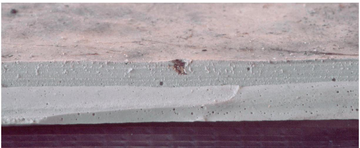
**Abb. 3 - 5: Schnitt durch die Abdichtung mit Poren**
