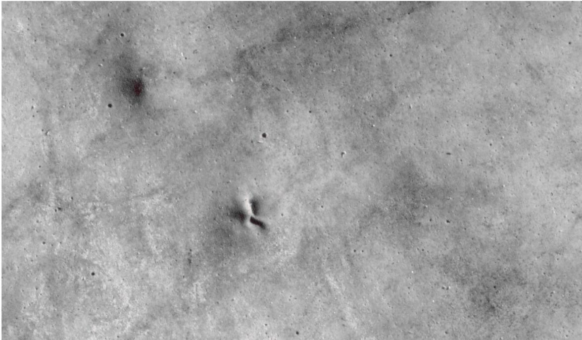
**Abb. 1: Poren in der Oberfläche der Abdichtung**
