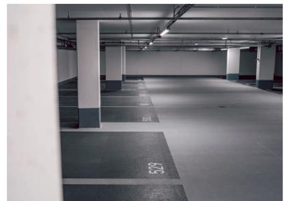
Die farbige Versiegelung Wecryl 488 bindet den Quarzsand sicher in die Beschichtung ein und sorgt für optisch sehr ansprechende Endergebnisse.
