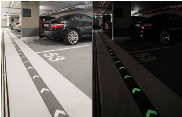
Für die Markierung der Fluchtwege wurden ebenfalls PMMA-Materialien, jedoch mit eingemischten Nachleuchtmitteln verwendet. So finden im Notfall die Kunden auch bei Dunkelheit den sicheren Fluchtweg ins Freie.
