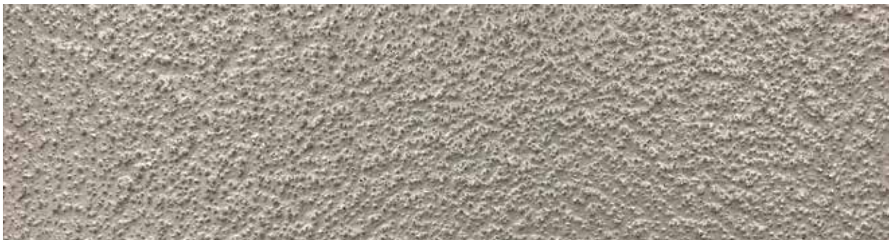
Absandung mit Quarzsand im Überschuss inkl. farblicher Versiegelung - Rutschhemmung R12
