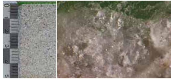
Bild 2: Penetrationstiefe von herkömmlichen PMMA-Harzen
