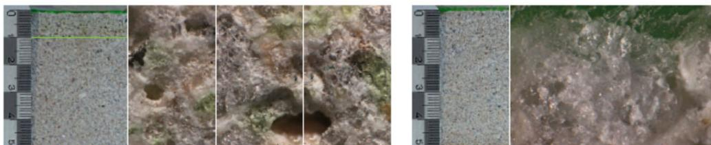
Abb. 1: Wirkung der Penetrationstiefen bei Wecryl 130 bei 8 °C Untergrundtemperatur (links) im Vergleich zu herkömmlichen PMMA Harzen (rechts).
